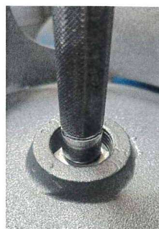
Fot. 3. Wskazanie dla gwintu niespełniającego kryterium akceptacji
