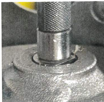
Fot. 4. Wskazanie dla gwintu spełniającego kryterium akceptacji po dodatkowej kontroli gwintu
